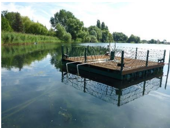
Schwimmponton mit Belüftungseinheit
