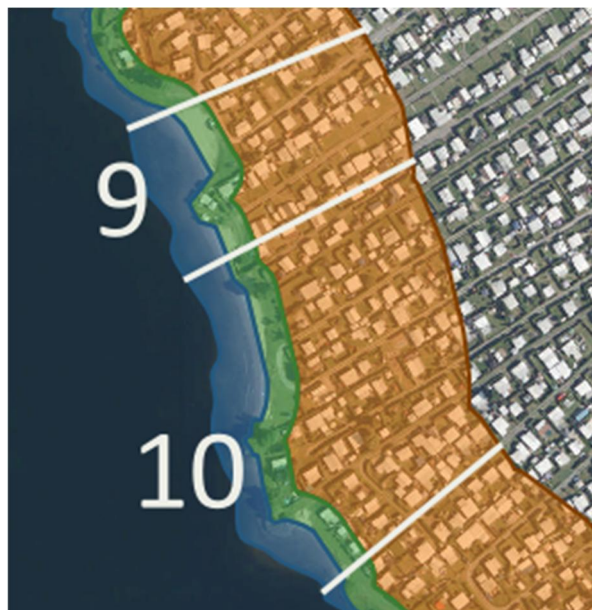
Abbildung 16: Übersicht Uferabschnitt 9 u. 10 mit Flachwasserzone (blau), Uferzone (grün) und Umfeldzone (orange).
