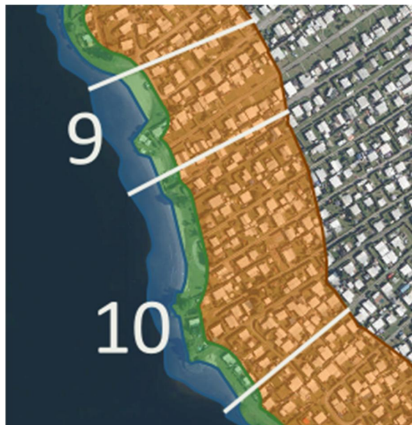
Abbildung 15: Übersicht Uferabschnitt 9 u. 10 mit Flachwasserzone (blau), Uferzone (grün) und Umfeldzone (orange).
