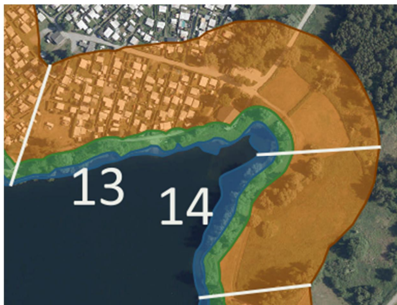
Abbildung 20: Übersicht Uferabschnitt 13 u. 14 mit Flachwasserzone (blau), Uferzone (grün) und Umfeldzone (orange).
