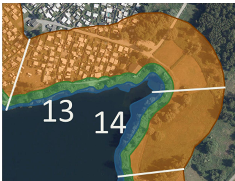
Abbildung 19: Übersicht Uferabschnitt 13 u. 14 mit Flachwasserzone (blau), Uferzone (grün) und Umfeldzone (orange).
